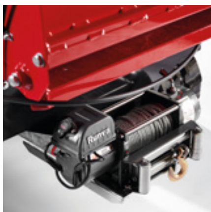
TP Spil kan anvendes, når flishuggeren skal op eller ned af skråninger
