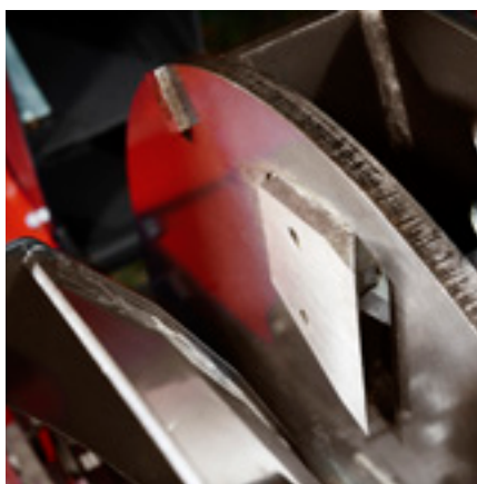
TP Opticut: To forskudte knive er konstant i kontakt med materialet
